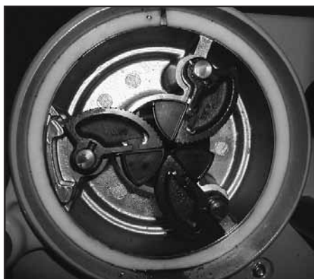
Fig. 4: Vorderes Spannfutter (19) Fig. 4: Front chuck (19) Fig. 4: Mandrin avant (19) Fig. 4: Mandrino anteriore (19) Fig. 4: Mandril de sujeción anterior (19) Fig. 4: Voorste spannklaauw (19) Fig. 4: Främre spännchuck (19) Fig. 4: Fremre spennchuck (19) Fig. 4: Forreste patron (19) Kuva 4: Etuistukka (19) Fig. 4: Mordentes de aperto anteriores (19) Rys. 4: Przedni uchwyt zaciskowy (19) Obr. 4: Přední sklíčadlo (19) Obr. 4: Predné sklíčovadlo (19) 4. ábra: Első tokmány (19) Sl. 4: Prednji stezni uložak (19) Slika 4: Sprednja vpenjalna glava (19) Fig. 4: Mandrina anterioară (19) Фиг. 4: Передний зажимный патрон (19) Εικ. 4: Μπροστινός σφιγκτήρας (19) Resim 4: Ön sıkıştırma mandreni (19) Фиг. 4: Преден универсал (19) 4 pav.: Priekinis kumštelinis griebtuvas (19) Att. 4: Priekšējā spīles ietvere (19) Joonis 4: Eesmine pingutuspadrun (19)
